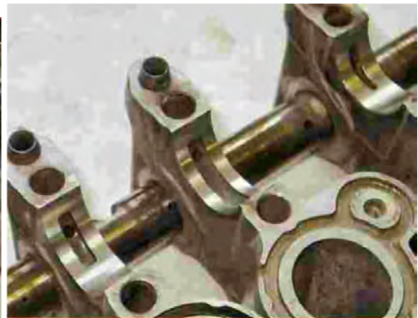
17.60. att. Sadales vārpstas blīvslēga sēžvietas izvirpošana un izvirpotas gultņu ligzdas
