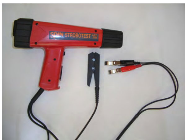
6.48. att. Stroboskops aizdedzes momenta noteikšanai Otto motoriem un dīzeļmotoriem:
