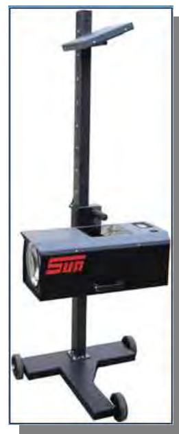
10.10.att. Apgaismošanas lukturu regulēšanas pārbaudes metodes un stands
