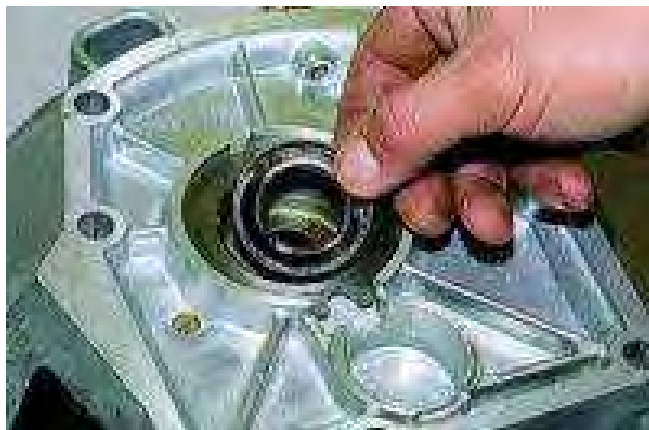
17.106. att. Pārnesumkārbas blīvslēga bojājums un nomaiņa
