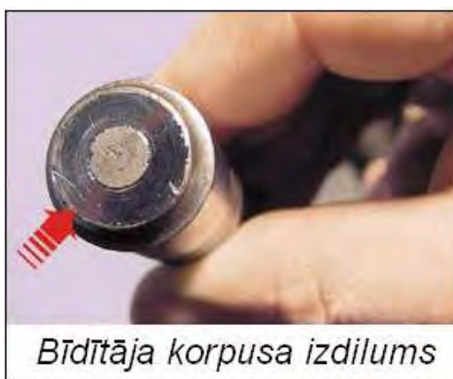
17.77. Bīdītāju defekti un hidrokompensatoru demontāža
