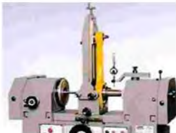
17.44.att. Klaņa apakšējās galvas urbuma izvirpošana (pa kreisi) un klaņa augšējās galvas urbuma izvirpošana (pa labi)
