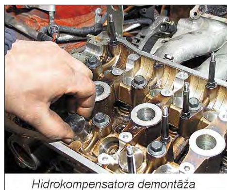
17.77. Bīdītāju defekti un hidrokompensatoru demontāža
