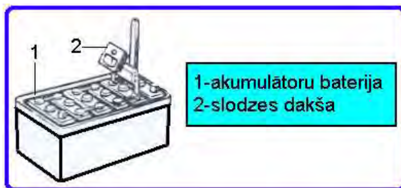
10.6.att. Akumulatora pārbaude ar slodzes dakšu
