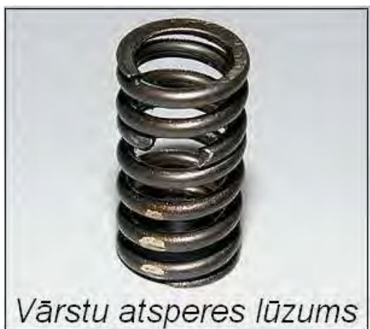
17.76.att. Vārstu atsperes defekti un pārbaude
