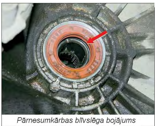
17.106. att. Pārnesumkārbas blīvslēga bojājums un nomaiņa
