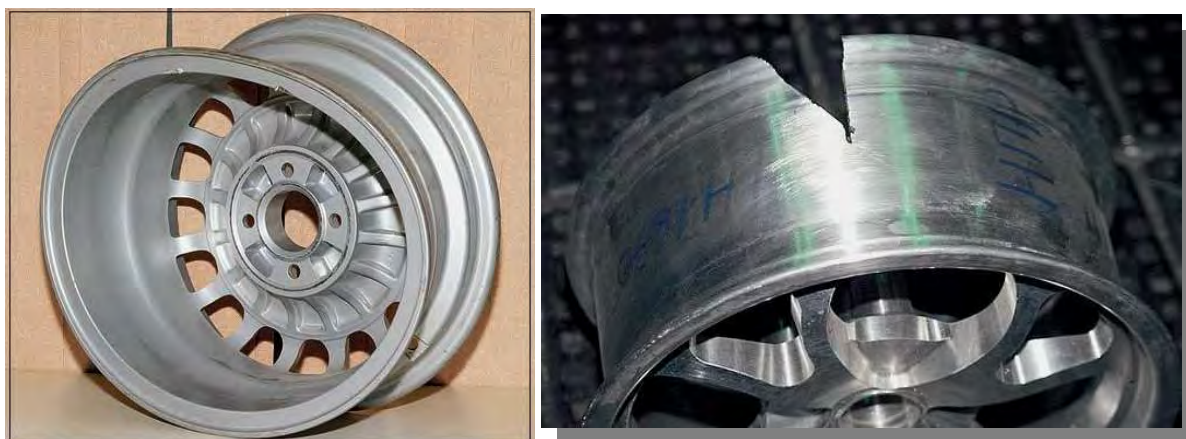
Diska deformācijas un elementu izlūzumi
