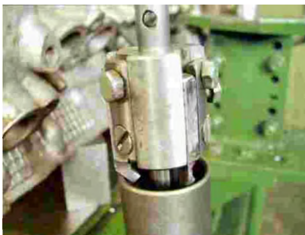
17.71. att. Griežņu bloku iestādīšana pēc šablona.
