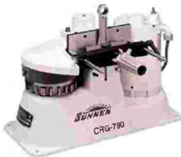
17.43.att. Sunnen firmas ierīce CRG-780 (pa kreisi) un klaņa urbuma slīpēšana (pa labi)
