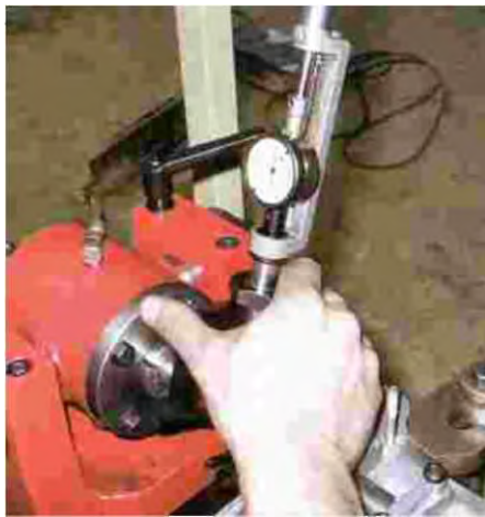
17.58 att. Griežņa izbīdījumu iestādīšana.
