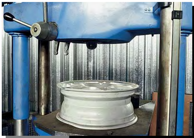
17.126.att. Riteņu disku taisnošana izmantojot speciālu palīgierīci
