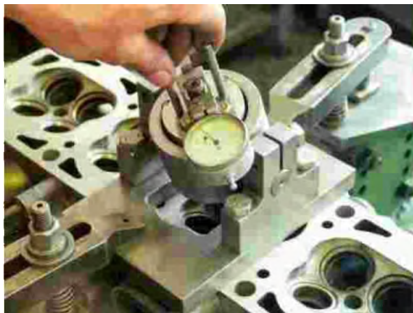
17.72.att. Adaptera iestādīšana pēc pulksteņindikatora.
