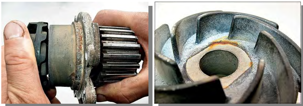
17.81.att. Ūdens sūkņu defekti
