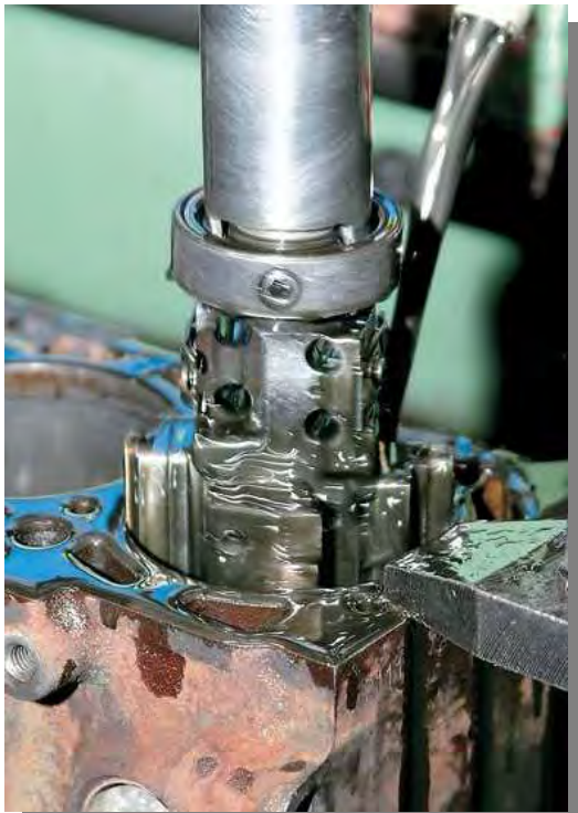
17.15.att. Honēšanas iekārta un honēšanas galviņas ar galodiņām
