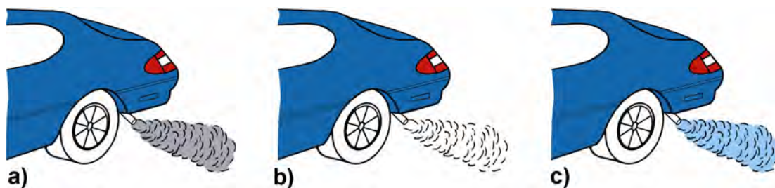
6.60. att. Bojātu dīzeļmotoru atgāzes:
