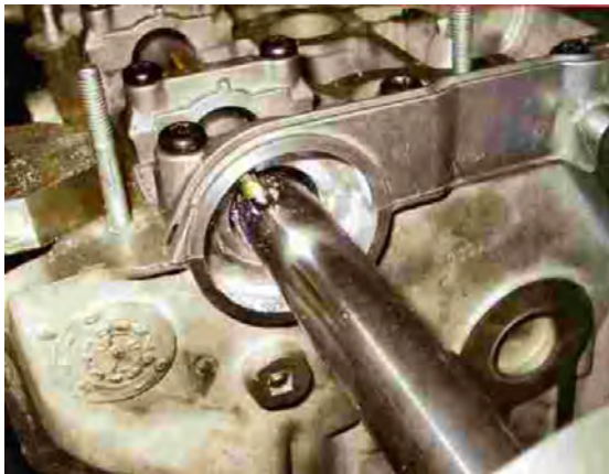
17.60. att. Sadales vārpstas blīvslēga sēžvietas izvirpošana un izvirpotas gultņu ligzdas
