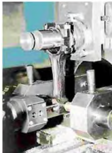
17.44.att. Klaņa apakšējās galvas urbuma izvirpošana (pa kreisi) un klaņa augšējās galvas urbuma izvirpošana (pa labi)
