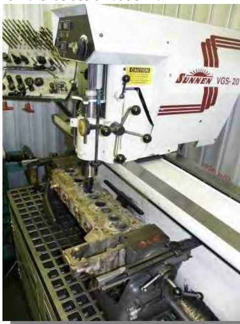
17.69.att. Vārstu ligzdas apstrādes speciālie darbgaldi un palīgierīce
