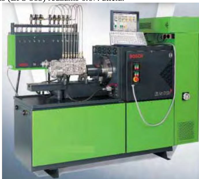
6.67. att. Augstspiediena sūkņu pārbaudes stands
