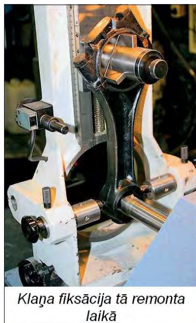
17.41.att. Klaņa izlieces mērīšana un klaņa fiksācija remonta laikā
