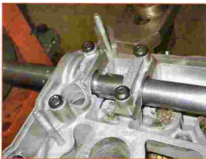
17.57. att. Izvirpošanas tapnis ievietots caur sadales vārpstas gultņiem.
