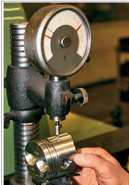
Virzuļa izmēru noteikšana izmantojot indikatora tipa mērierīci
