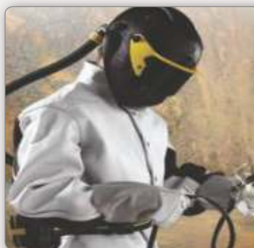
6.5. tēmas 13. attēls. Metinātāja maska ar gaisa pievadu pa lokanu cauruļvadu
