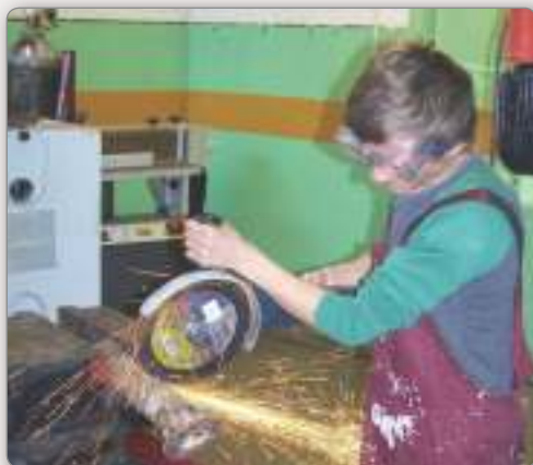
6.5. tēmas 7. attēls. Pareizs darbs ar diska griezēju. Detaļa iespīlēta, un nodarbinātajam ir aizsargbrilles
