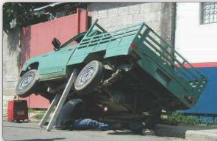
6.2. tēmas 1. attēls. Neatbilstoši pacelts un nostiprināts automobilis
