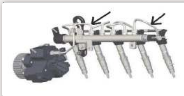
6.5. tēmas 36. attēls. Dīzeļdzinēja barošanas sistēmas mehāniskā daļa ar norādēm uz riska zonas
