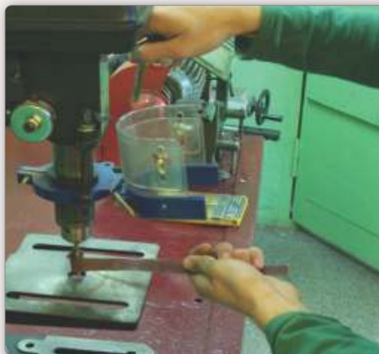
6.5. tēmas 20. attēls. Nodarbinātais strādā ar paceltu aizsargu, urbjamā metāla loksnīte nav nostiprināta. Inscinēts pārkāpums un traumatisma risks
