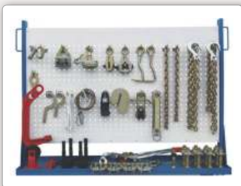
6.5. tēmas 25. attēls. Viegļā automobiļa virsbūves taisnošanas stenda satveršanas un vilkšanas ierīču komplekts
