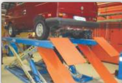
6.5. tēmas 17. attēls. Automobilis nodrošināts pret noripošanu no platformas
