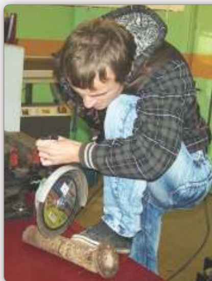
6.5. tēmas 8. attēls. Bīstams darbs ar diska griezēju. Detaļa tiek piespiesta ar kāju, netiek lietotas aizsargbrilles. Nodarbinātajam nav specapģērba. Inscinēts foto mācību mērķim
